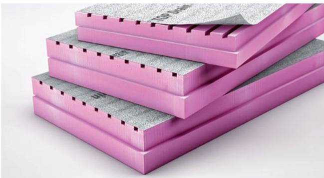
Witterungsunabhängigkeit wird auch durch die hohe Frost-Tau-Wechselbeständigkeit gewährleistet. Um dem Klima in Mitteleuropa Paroli zu bieten, brauchen Dämmplatten diese Eigenschaft. Austrotherm XPS® ist auch hier vorbildlich: Die Platten nehmen sogar nach 300 Frost-Tau-Wechseln nicht mehr als zwei Prozent Feuchtigkeit auf.
