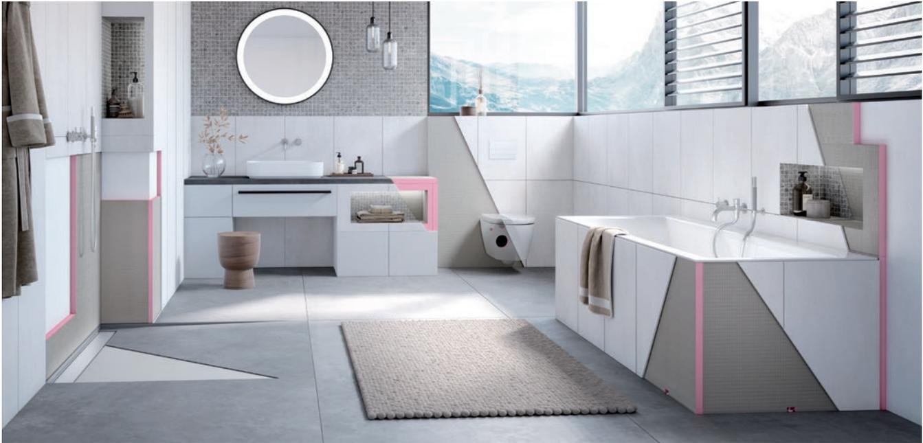
Die Austrotherm UNIPLATTE® ist das passende Trägerelement für Boden- und Wandverkleidungen, vor allem in Räumen mit hoher Luftfeuchtigkeit. Sie besteht aus einer beidseitigen, mit Textilglasgitter armierten Spezialmörtelbeschichtung und einem rosa, hochwärmedämmenden Kern aus extrudiertem Polystyrolhartschaum (Austrotherm XPS®).
