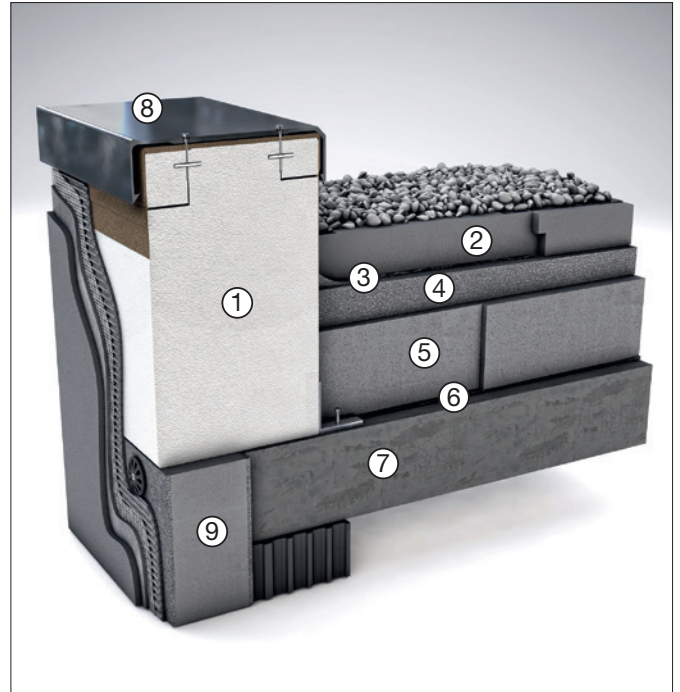
Attika Bauweise mit dem neuen Austrotherm Attikaelement – spart Materialkosten und Zeitaufwand
