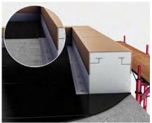
Variante: Verklebung bündig zum Mauerwerk:
