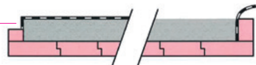
Fundamentschalung mit Horizontalabdichtung
