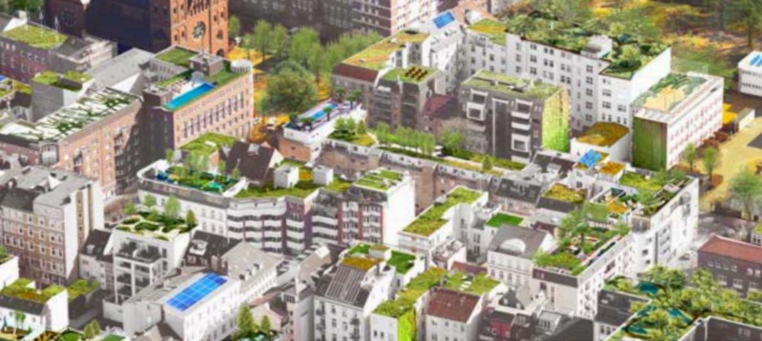
einer Traglast von etwa 150 Kilogramm pro Quadratmeter. Die Wurzeln der sich weitestgehend selbst erhaltenden Pflanzen dringen nicht so tief in den Boden ein, für die Begrünung reicht daher schon ein Aufbau ab zehn Zentimeter aufwärts.
