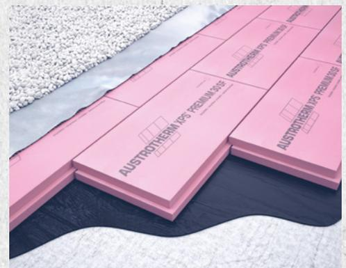
Umkehrdach mit Austrotherm XPS® – die sichere Lösung
