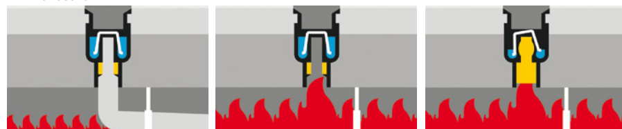
Rohr löst sich
