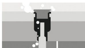
Fuite de fumée / gaz
