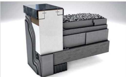
Mit integrierten Kunststoffleisten zur Befestigung der Verblechung
