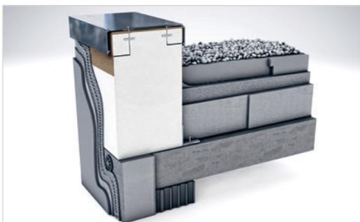
Mit integrierten Kunststoffleisten zur Befestigung der Verblechung
